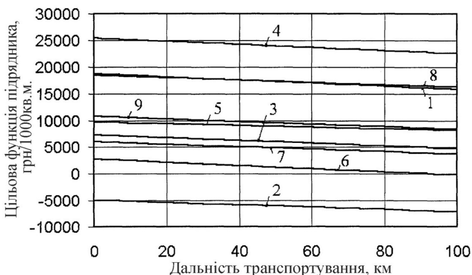
Рисунок 3.14 Залежність ефективності технологій від дальності транспортування матеріалів (при 70 метрах погонних примикань на 100 м 2 покрівельного покриття і висоті виконання робіт 25м)
