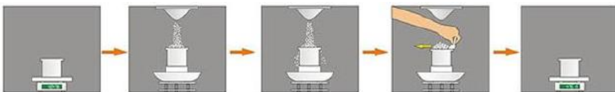
Рисунок 2.4 - Вимірювання насипної щільності обпаленого бокситу на волюмометрії
