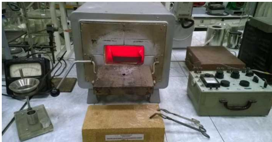
Рисунок 2.3 - Термічна активація бокситу на нікелевому піддоні
