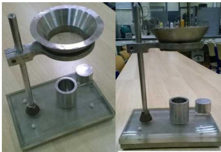
Рисунок 2.4 - Вимірювання насипної щільності обпаленого бокситу на волюмометрії
