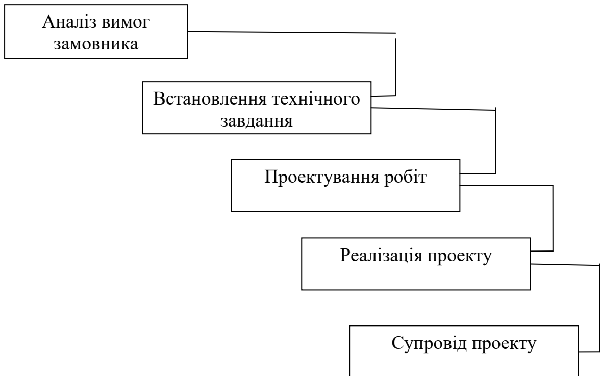
Рисунок 1.3 – Каскадна модель життєвого циклу управління проектом
