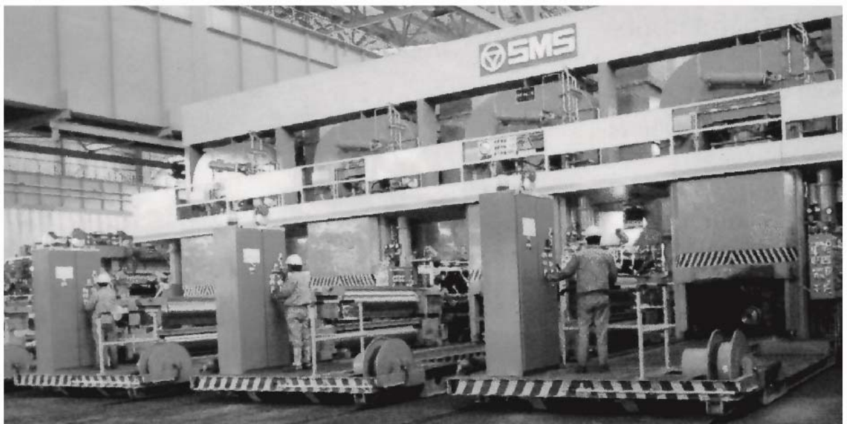
Рисунок 1.18 – Неперервний стан – тандем з пристроями для перевалки валків
