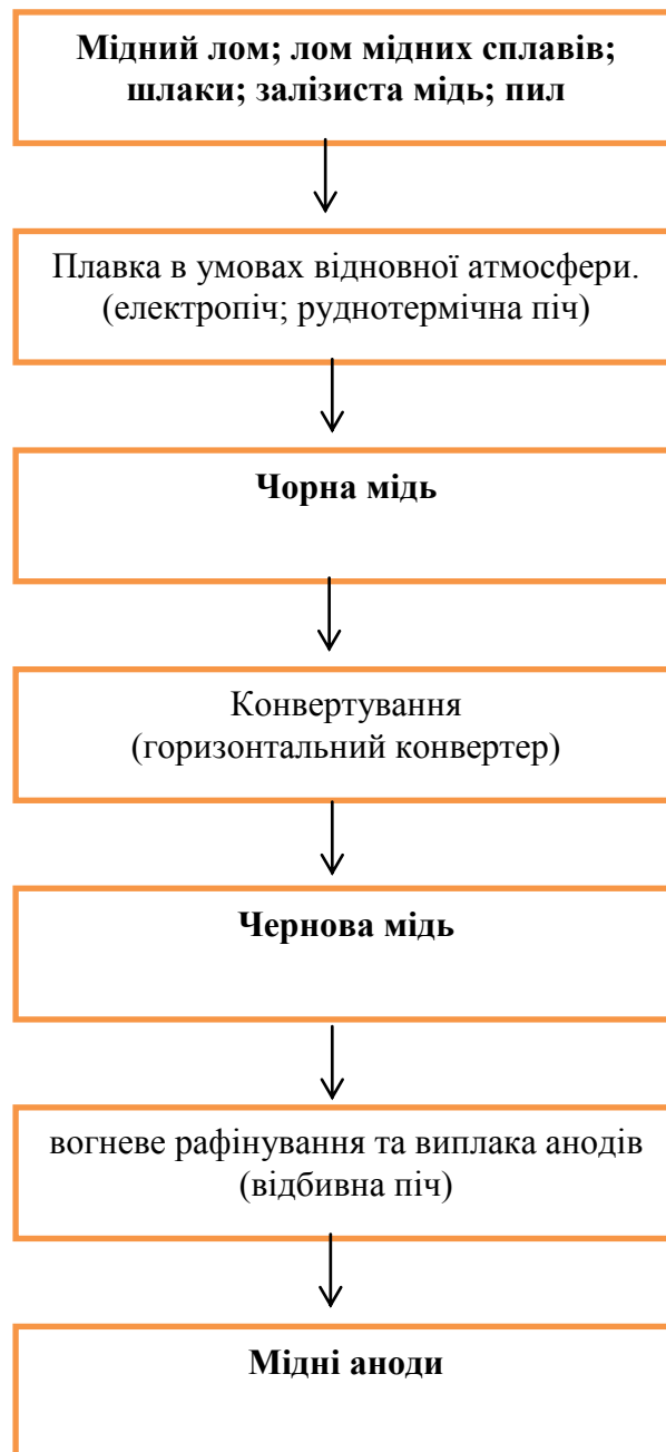
Рисунок 1.1 - Схема технологічного процесу виробництва вторинної міді
