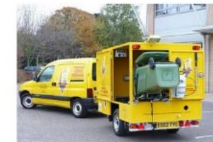
Фото. Обладнання для миття контейнерів на причепах
