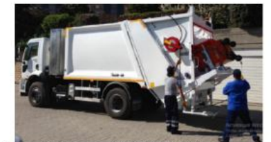
Фото. Сміттєвоз НІДРО МАК з функцією миття та дезінфекції контейнерів
