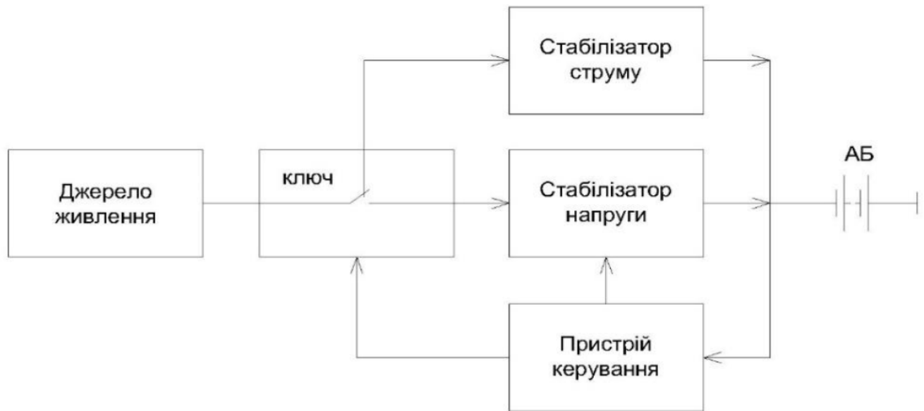
Рисунок 4.1 – Структурна схема зарядного пристрою за методом CC/CV
