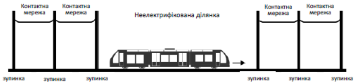
Рисунок 1.5 – Спрощена конфігурація випадку проходження по електрифікованих і неелектрифікованих ділянках ЕРС з ESS накопичувачем
