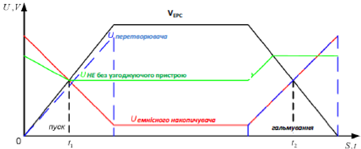
Рисунок 1.10 – Діаграма швидкості ЕРС і напруг на ємнісному накопичувачі з узгоджувачим пристроєм і без нього при пуску і гальмуванні
