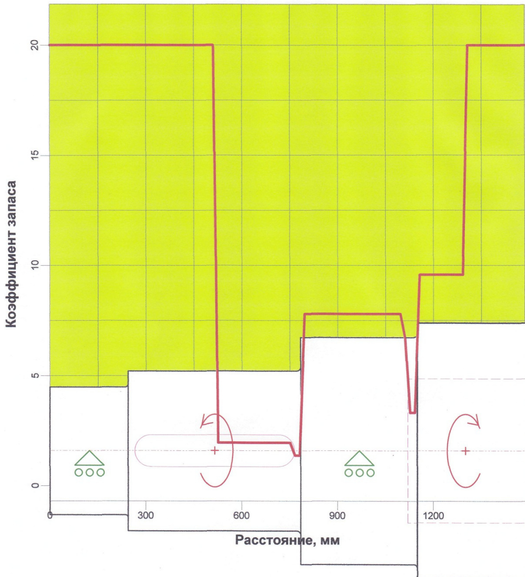
Рисунок 2.3 – Епюра коефіцієнт запасу надійності по втомній міцності вала
