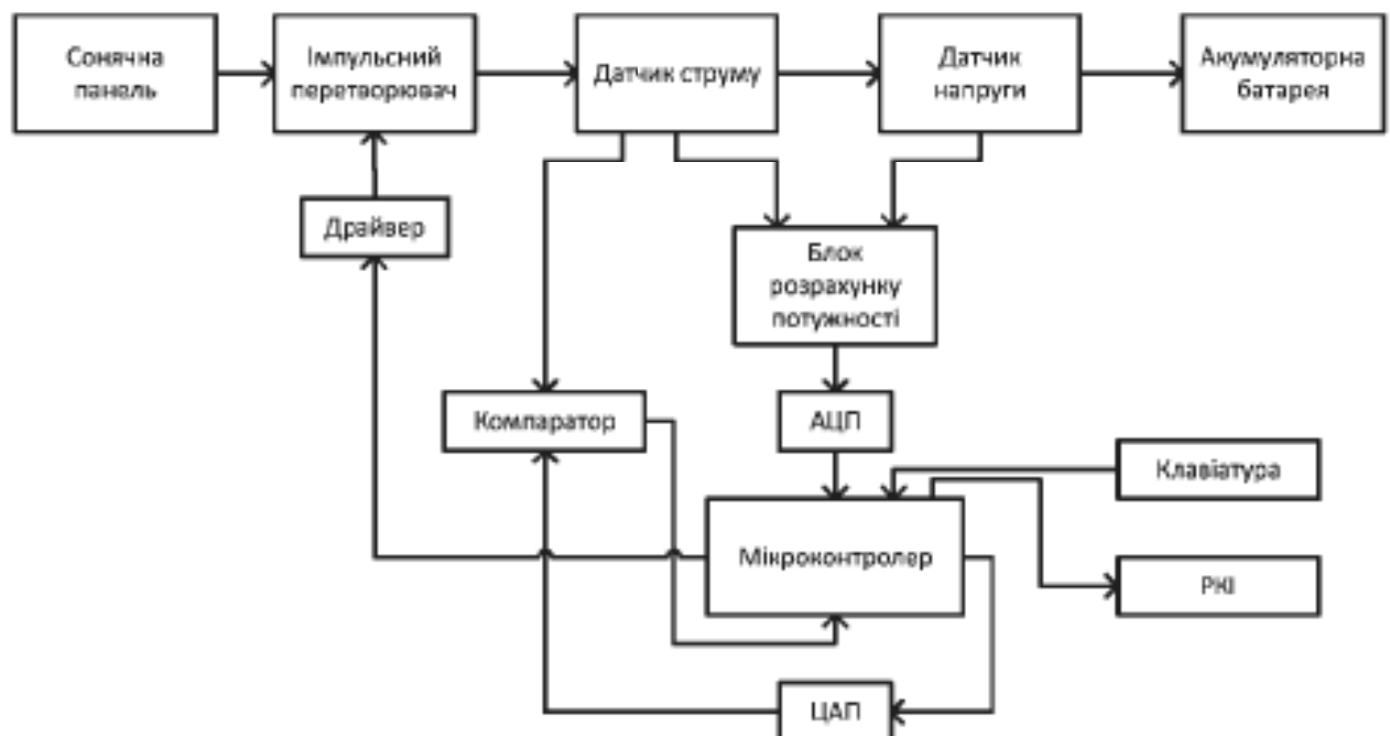
Рисунок 3.1 - Структурна схема контролера заряду з живленням від сонячного модулю
