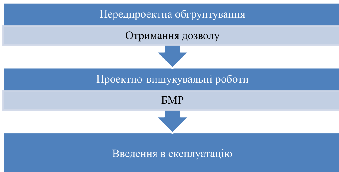
Рисунок 1.2 – Ланцюжок створена цінності будівельного виробництва
