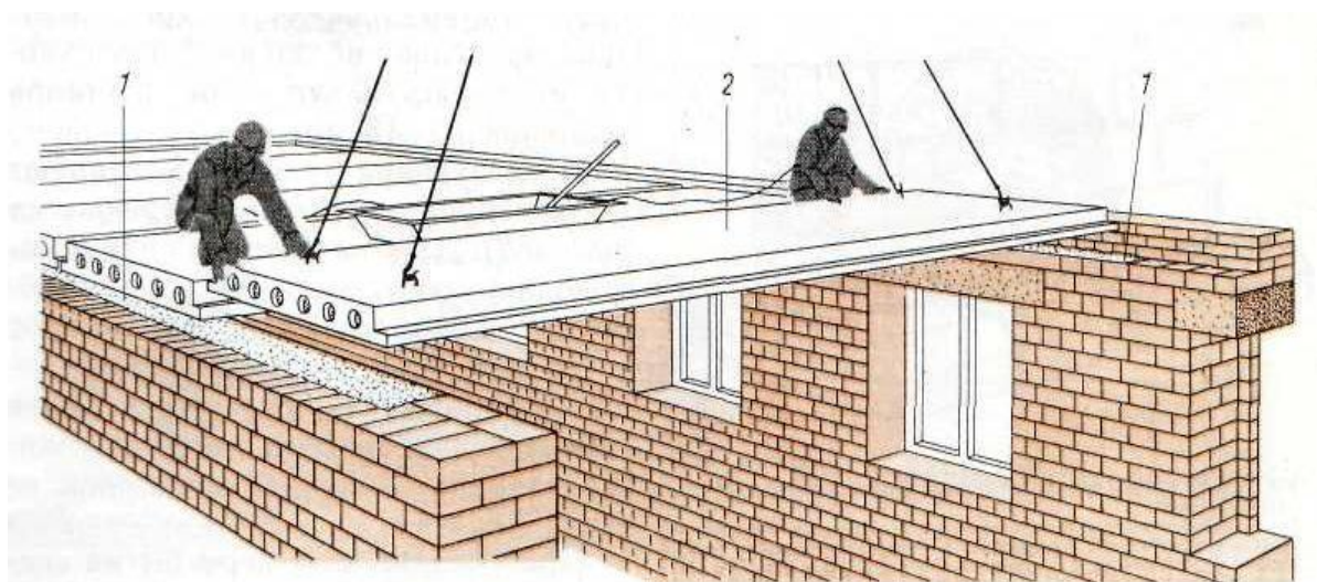
Рисунок 3.6 – Монтаж збірних залізобетонних конструкцій
