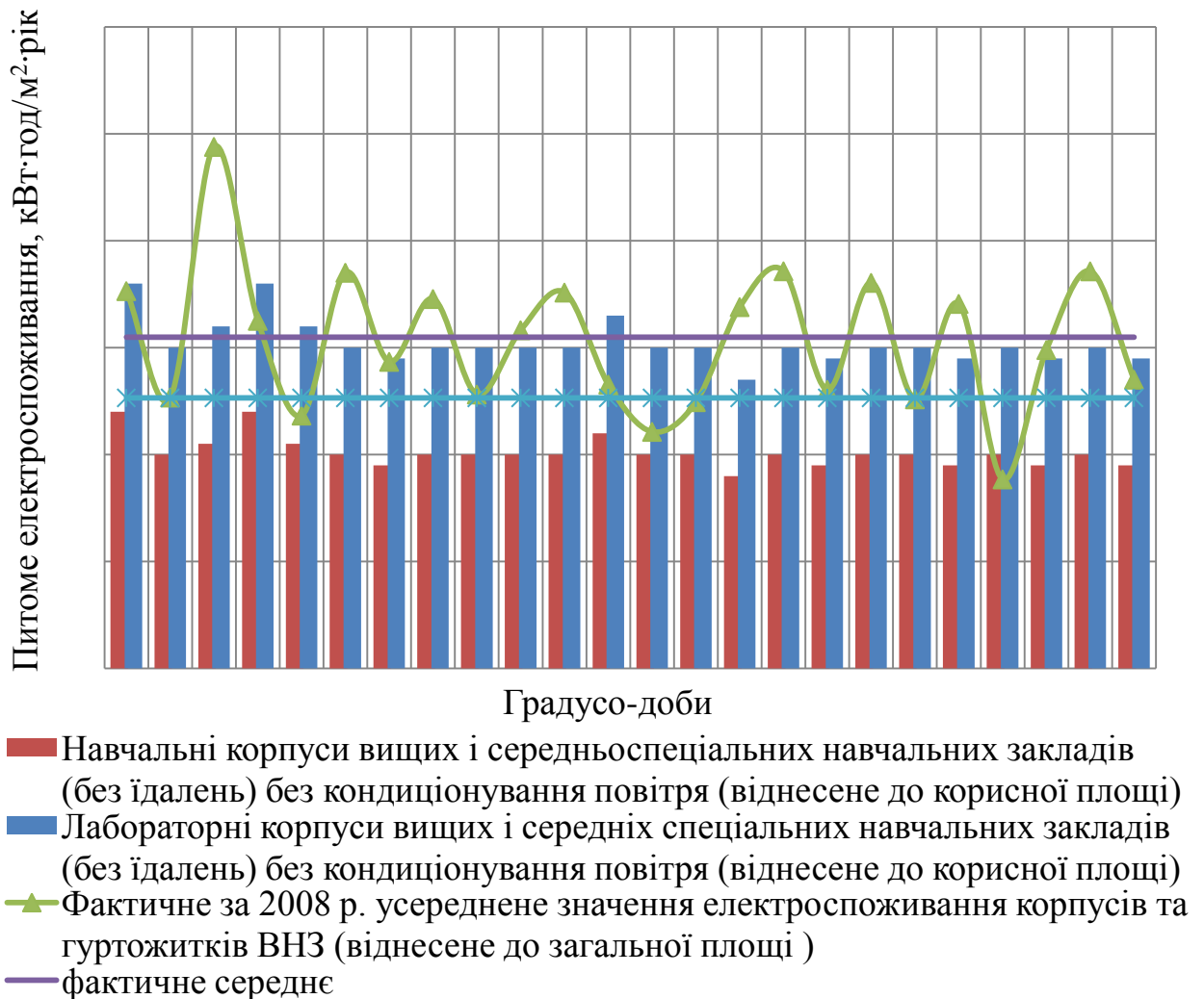
Рисунок 3.5 – Порівняння нормативних та фактичних витрат електричної енергії навчальними та лабораторними корпусами ЗВО
