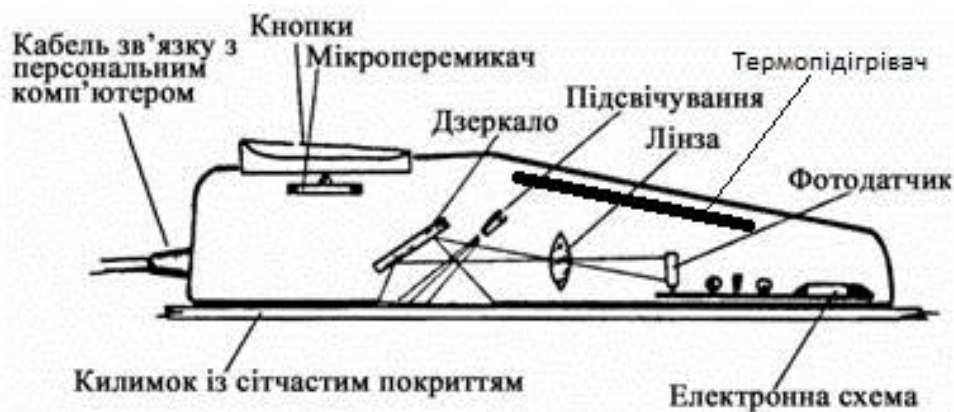
Рис. 1. Структура маніпулятора типу миша з термопідігрівом.
