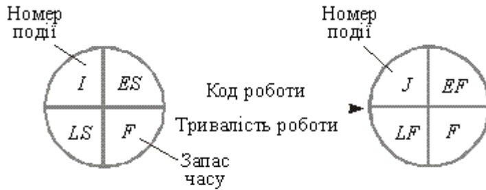
Рис. 6.10. Схема означення параметрів у стрілчастій ij -діаграмі
