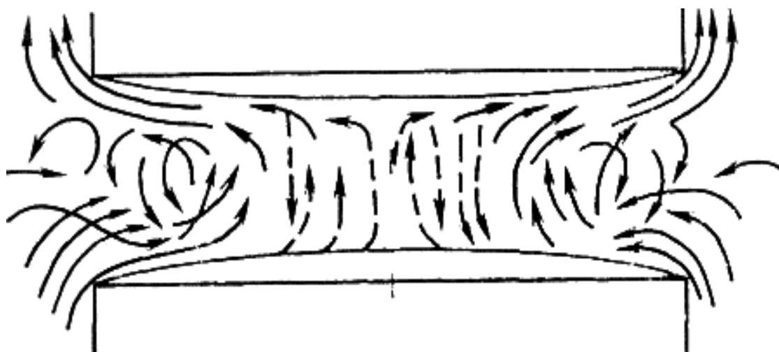
Рисунок 2.10 - Нерухомий масляний шар в горизонтальному каналі за даними експериментів Л. Кіша
