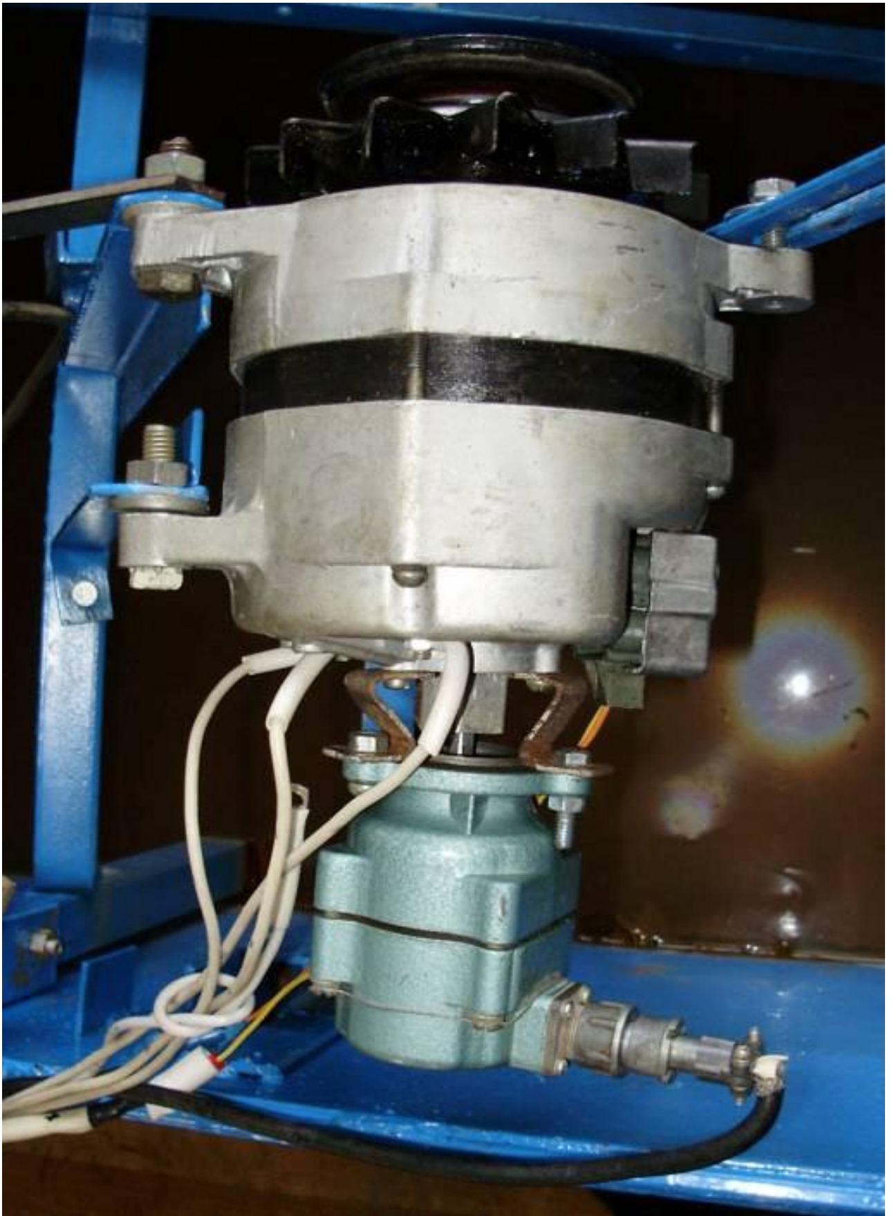
Рисунок 4.8, – Генератор трифазний синхронний змінного струму незалежного збудження з тахогенератором
