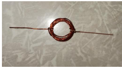
Рисунок 2.23 – Виготовлення мідної котушки
