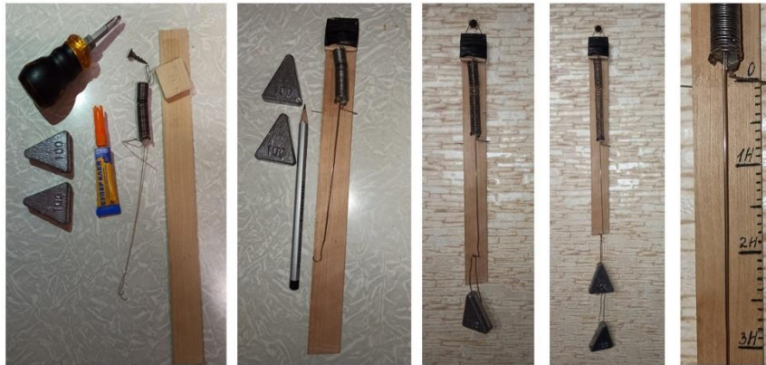
Рисунок 2.21 – Послідовність виготовлення динамометра
