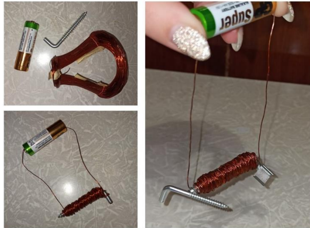
Рисунок 2.22 – Послідовність виготовлення електромагніту
