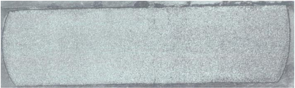
Рисунок 4.7 – Макроструктура деформованого зразку сталі 10ХФТч при температурі 850°C
