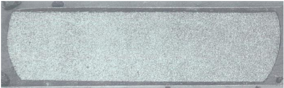
Рисунок 4.11 – Макроструктура деформованого зразку сталі 10ХФТч при температурі 950°C
