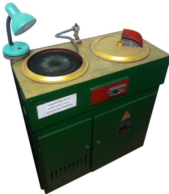
Рисунок 2.2 – Полірувальний верстат двошпindelний зі зміною кутової швидкості IP33
