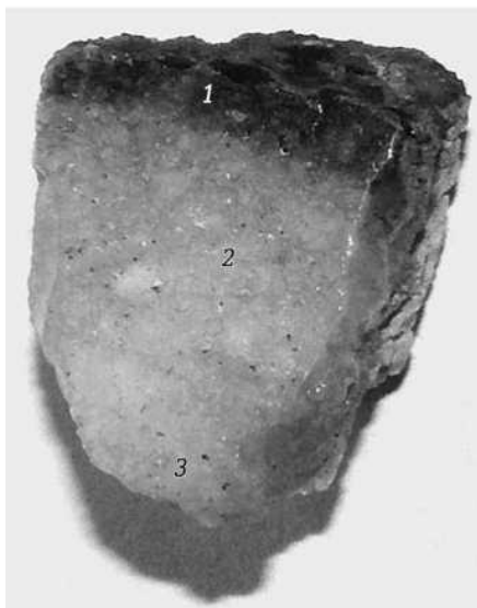
Рисунок 2.14 - Фрагмент футерування: 1 - робоча зона; 2 - перехідна зона; 3 - найменш змінена зона
