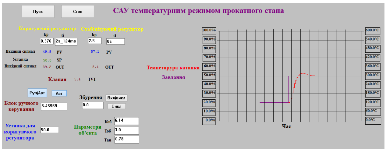
Рисунок 4.18 – Робота САУ при аперіодичному переходному процесу
