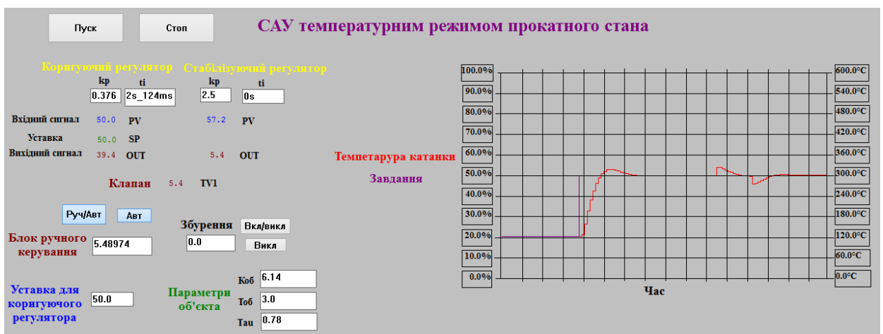
Рисунок 4.25 – Дослідження роботи САУ при збуренні
