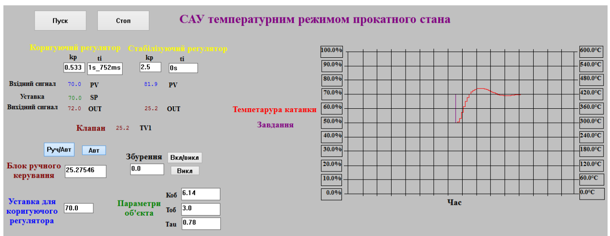
Рисунок 4.19 – Робота САУ при переходному процесу з 20% перерегулюванням
