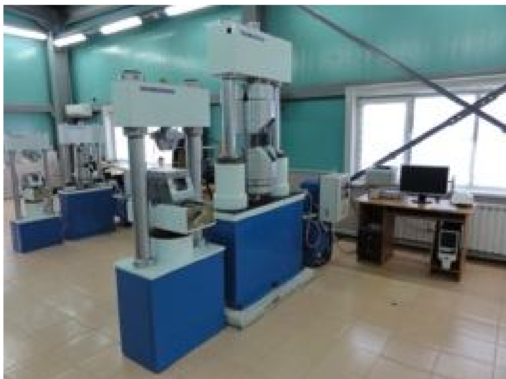
Рисунок 2.25 – Зразки металу піддаються випробуванню розривними гідравлічними машинами
