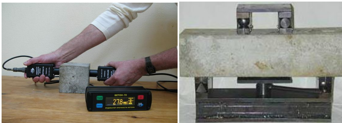
Рисунок 2.24 – Зразки для випробувань бетонних конструкцій
