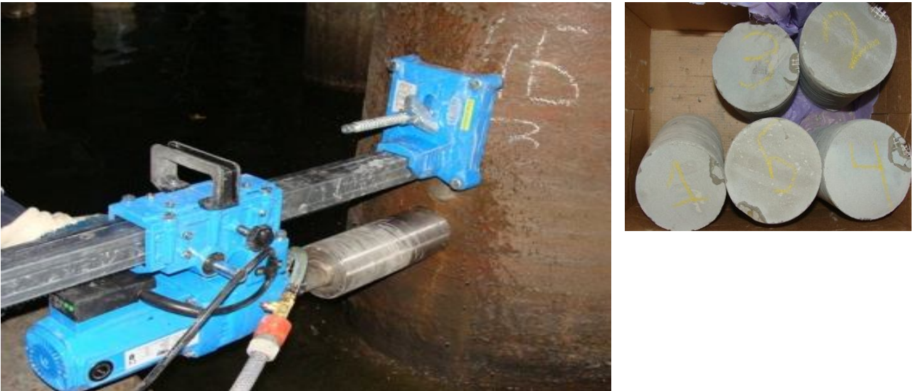
Рисунок 2.22 – Зразки, вибурені з існуючих конструкцій системами алмазного буріння
