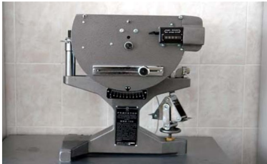
Рисунок 2.4 - Машина МП-100 для випробування балочок на вигин:
