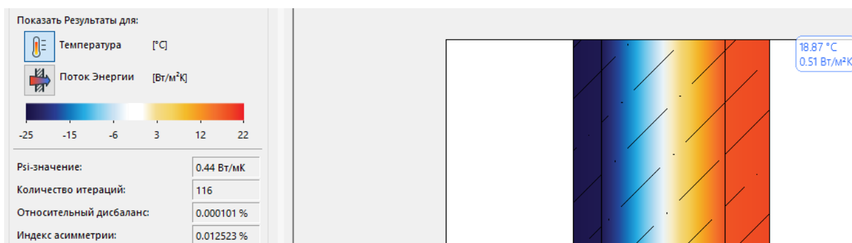
Рисунок 1.29 – Температура 18.87^\circ\text{C} у внутрішньої поверхні стінової панелі змодельованої за новими нормативними показниками та новими показниками температури зовнішнього та внутрішнього повітря
