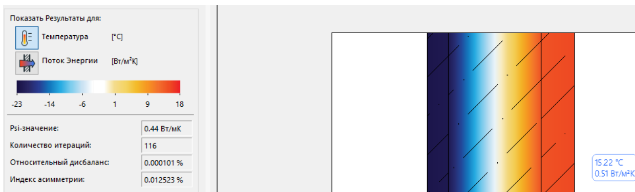
Рисунок 1.28 – Температура 15.21^\circ\text{C} у внутрішньої поверхні стінової панелі змодельованої за новими нормативними показниками та старими показниками температури зовнішнього та внутрішнього повітря
