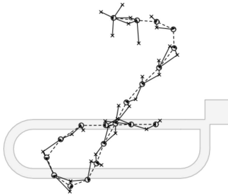
Рис. 19 Об'єднання одометрії з вимірами нових точок орієнтації
