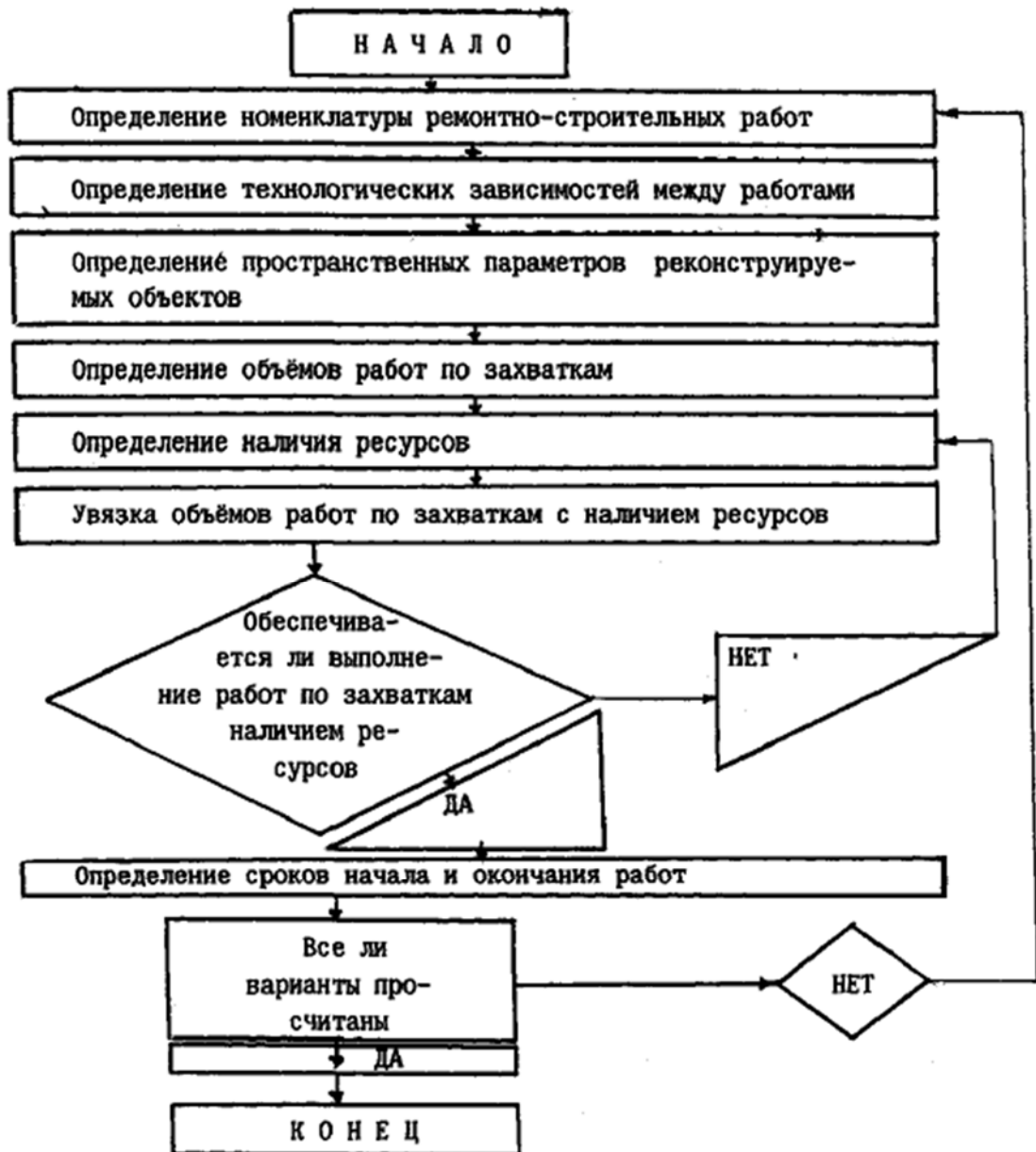
Рисунок 3.9 – Блок схема алгоритму формування організаційно-технологічних моделей
