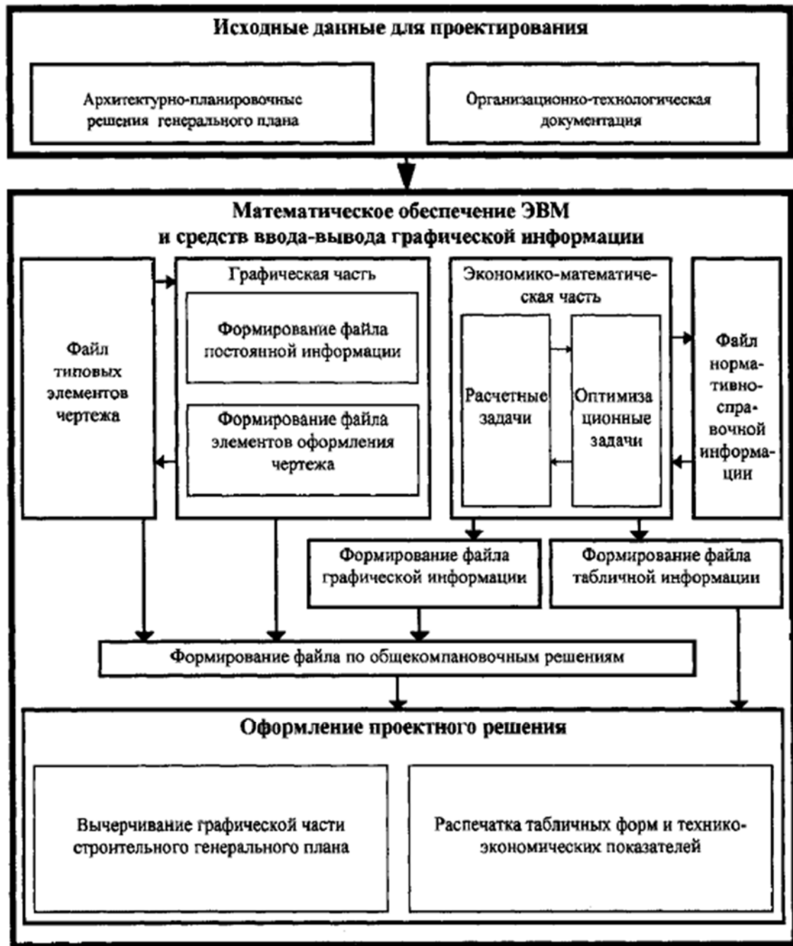
Рисунок 3.5 – Схема інформаційного забезпечення автоматизованого проектування будгетплану
