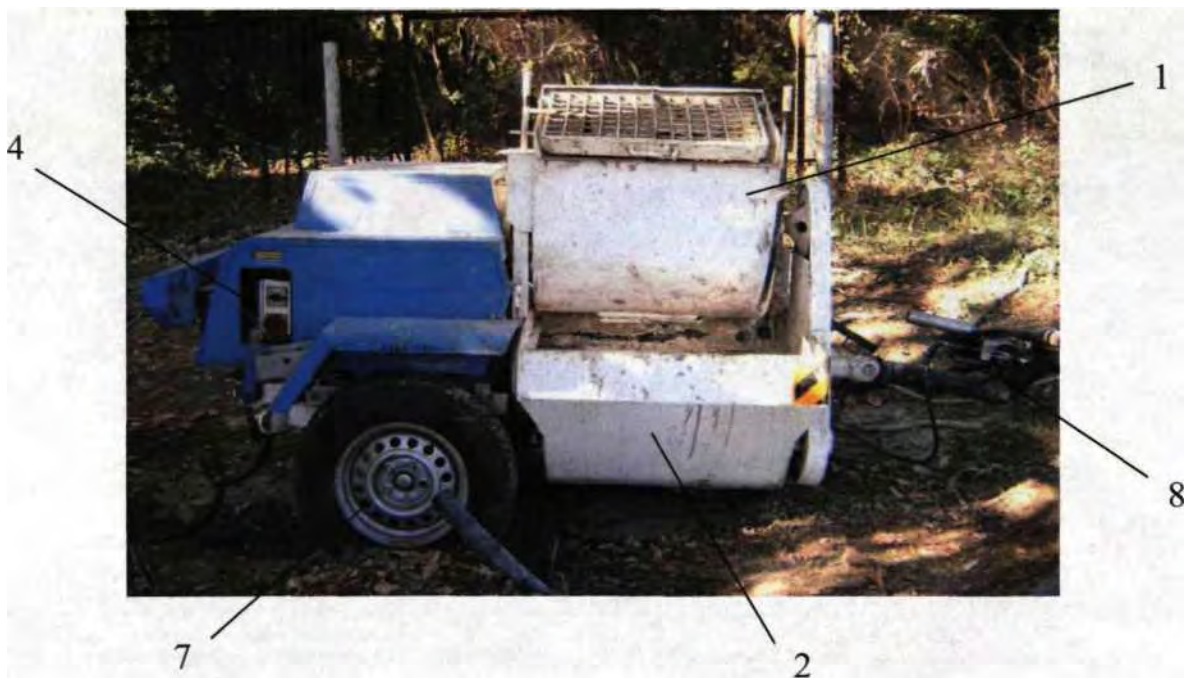
Рисунок 1.15 - Загальний вигляд торкрет-машини Р-13 для пневмонанесення бетонної суміші (позиції вказані на Рисунок 1.16)
