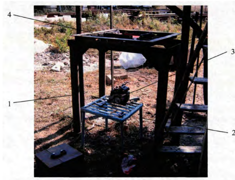
Рисунок 3.6 - Стенд для дослідження впливу струменя торкрет-бетону на пневмоопалубку
