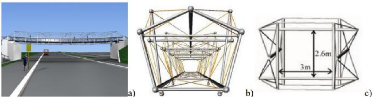
Рисунок 2.15 – Проект пішохідного мосту Тор Вергата у Римі, Італія: а) загальний вигляд моста; б і в) – модулі "тенсегріті" конструкції мосту
