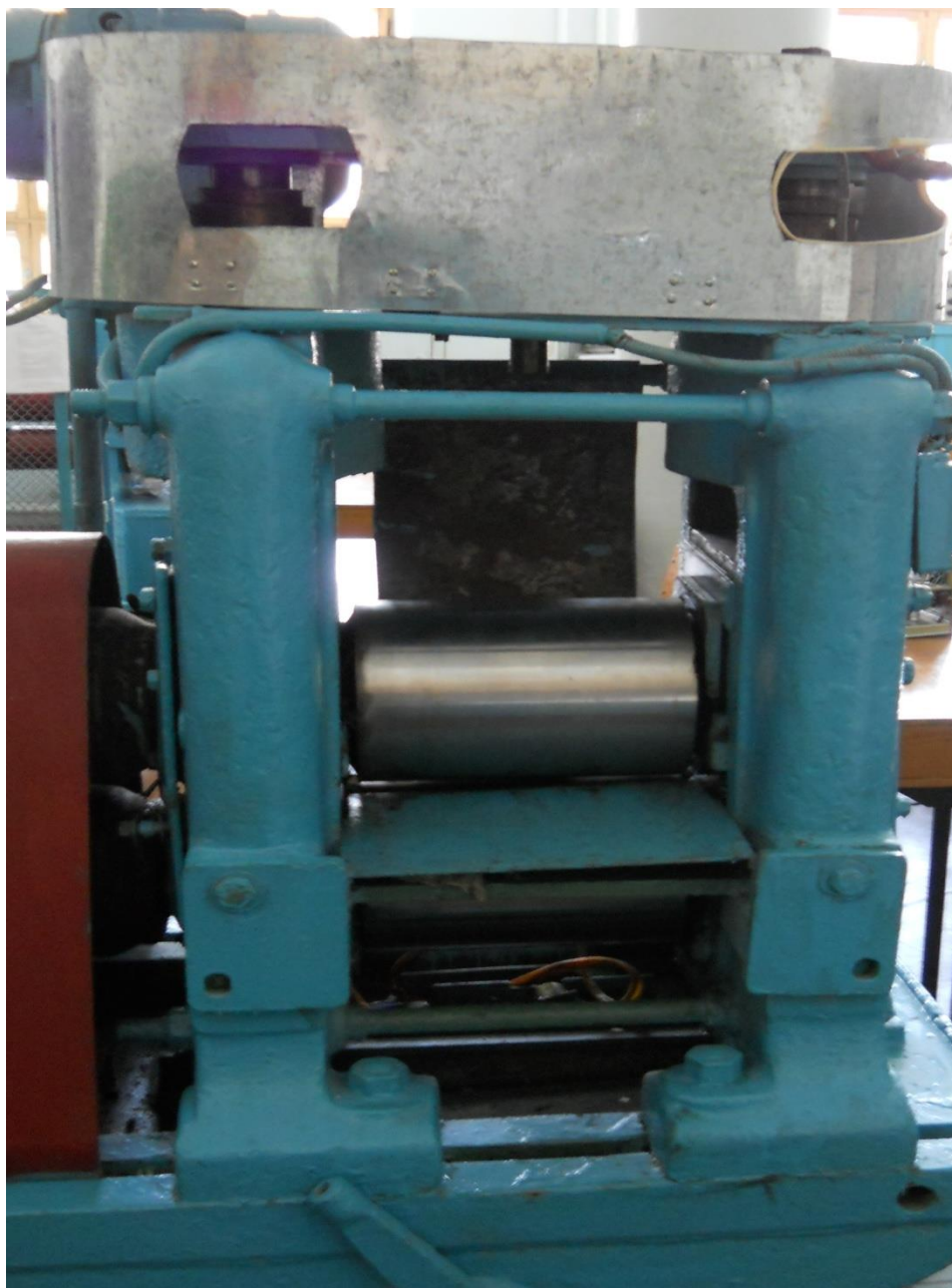
Рисунок 2.2 – Загальний вид робочої кліти лабораторного прокатного міні-стану 260x260.
