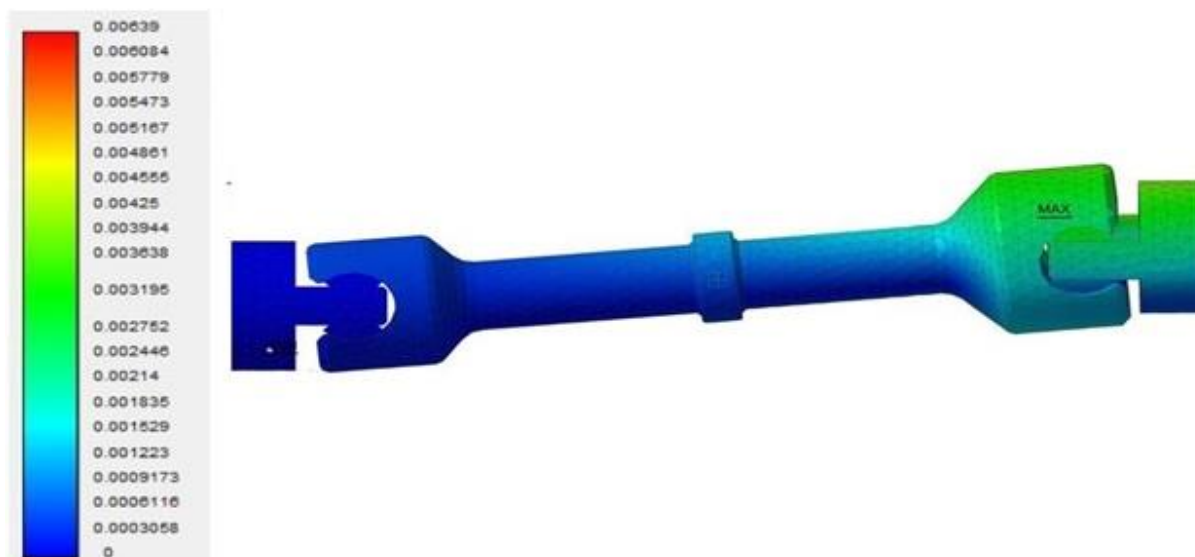
Рисунок 3.4 Епюри розподілу переміщень моделі універсального шпинделя
