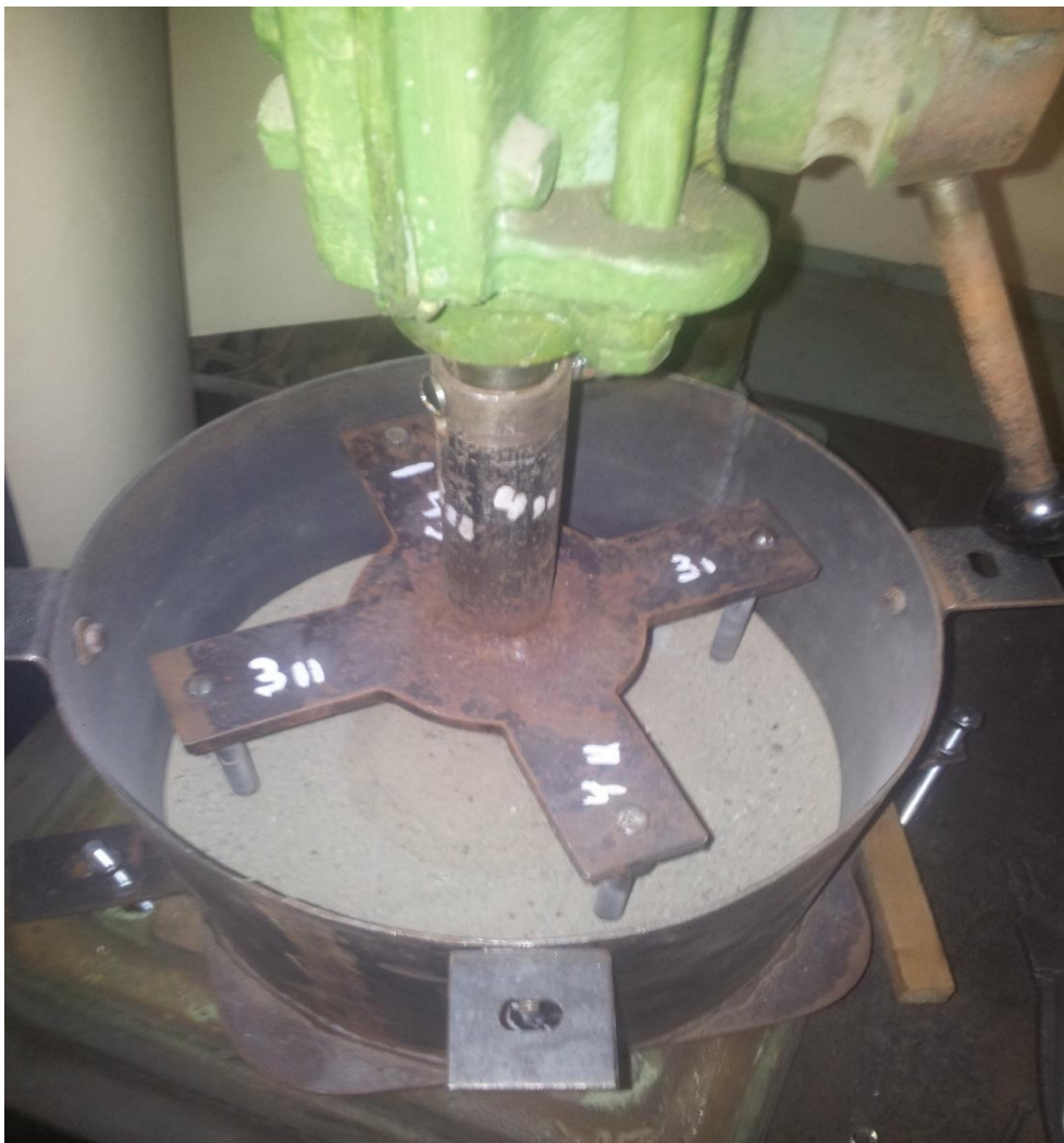
Рисунок 2.5 Вид конструкции с образцами и абразивным материалом
