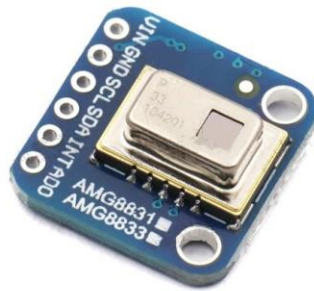
Рисунок 2.5 – Інфрачервоний тепловізор AMG8833
