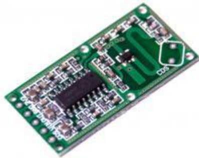
Рисунок 2.6 – Зовнішній вигляд датчику руху RCLW-0516
