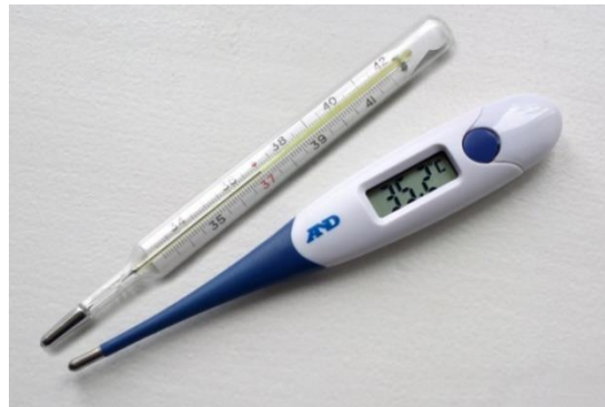
Рисунок 1.2 – Контактні медичні термометри: скляний та електронний
