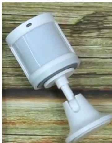
Рисунок 1.6 – Зображення датчику руху Aqara Motion Sensor
