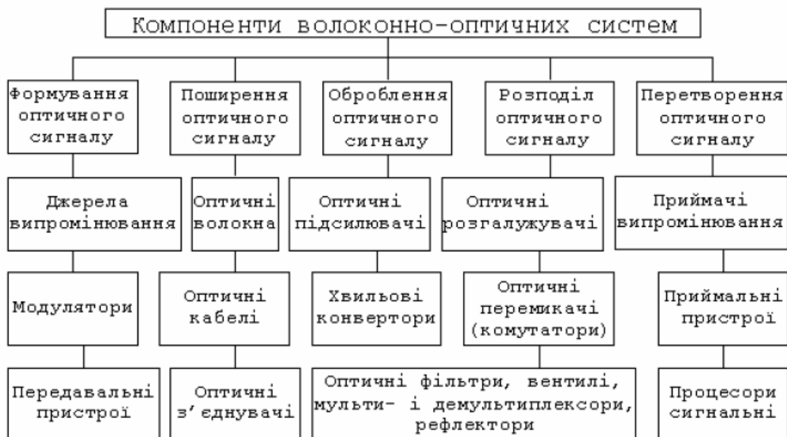
Рисунок 1.3 Класифікація основних компонентів волоконно-оптичних систем та мереж
