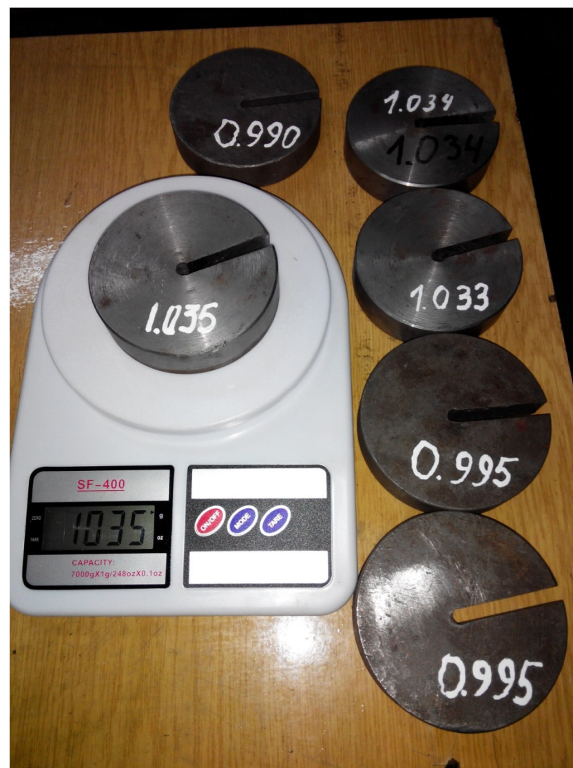
Рисунок 2.26 – Фотографія процесу тарування силовимірювача.
