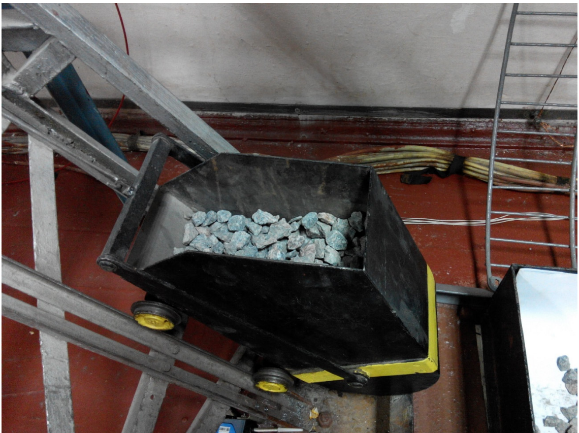
Рисунок 2.12 – Завантаження щебеню в скіп на рівні 50мм від верху.
