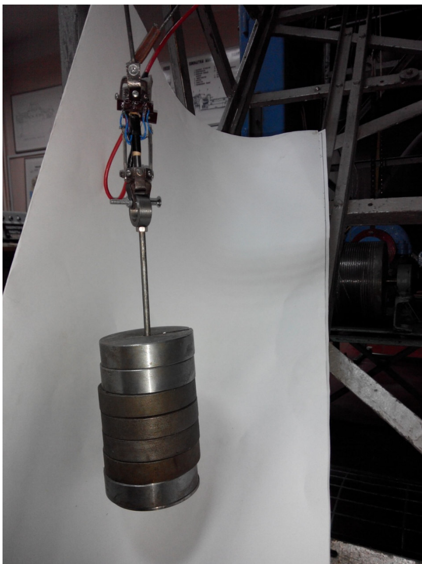
Рисунок 2.26 – Фотографія процесу тарування силовимірювача.
