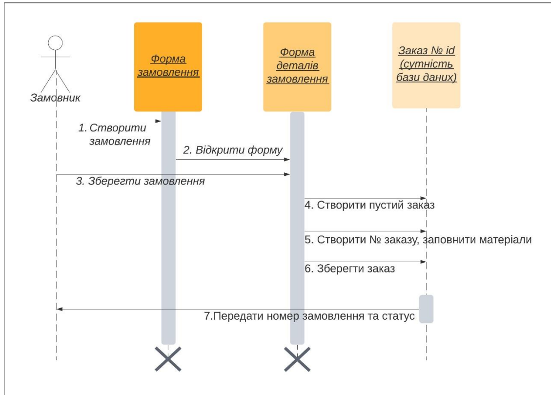
Рисунок 2.4 – Діаграма послідовності для варіанту використання «Створити замовлення»
