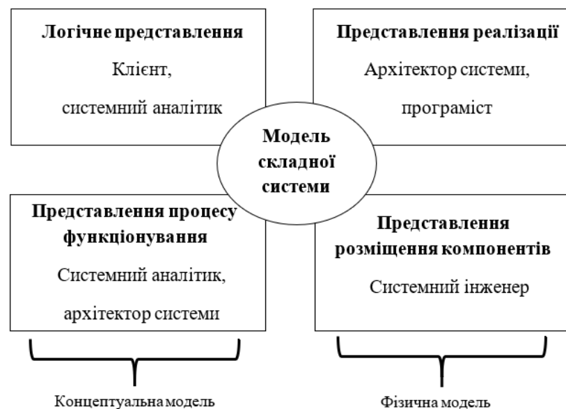
Рисунок 2.1 – Модель складної системи для проектування програмного забезпечення
