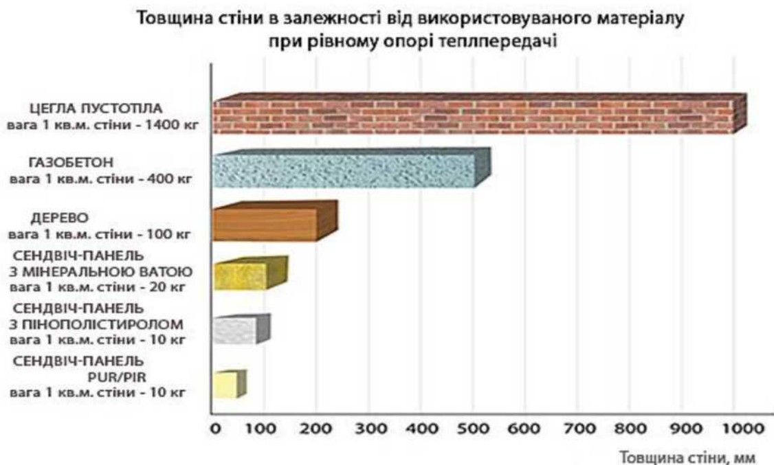
Рисунок - 1.5 Порівняльний аналіз товщини шару зовнішньої огорожувальної конструкції при приведеному однаковому опорі теплопередачі
