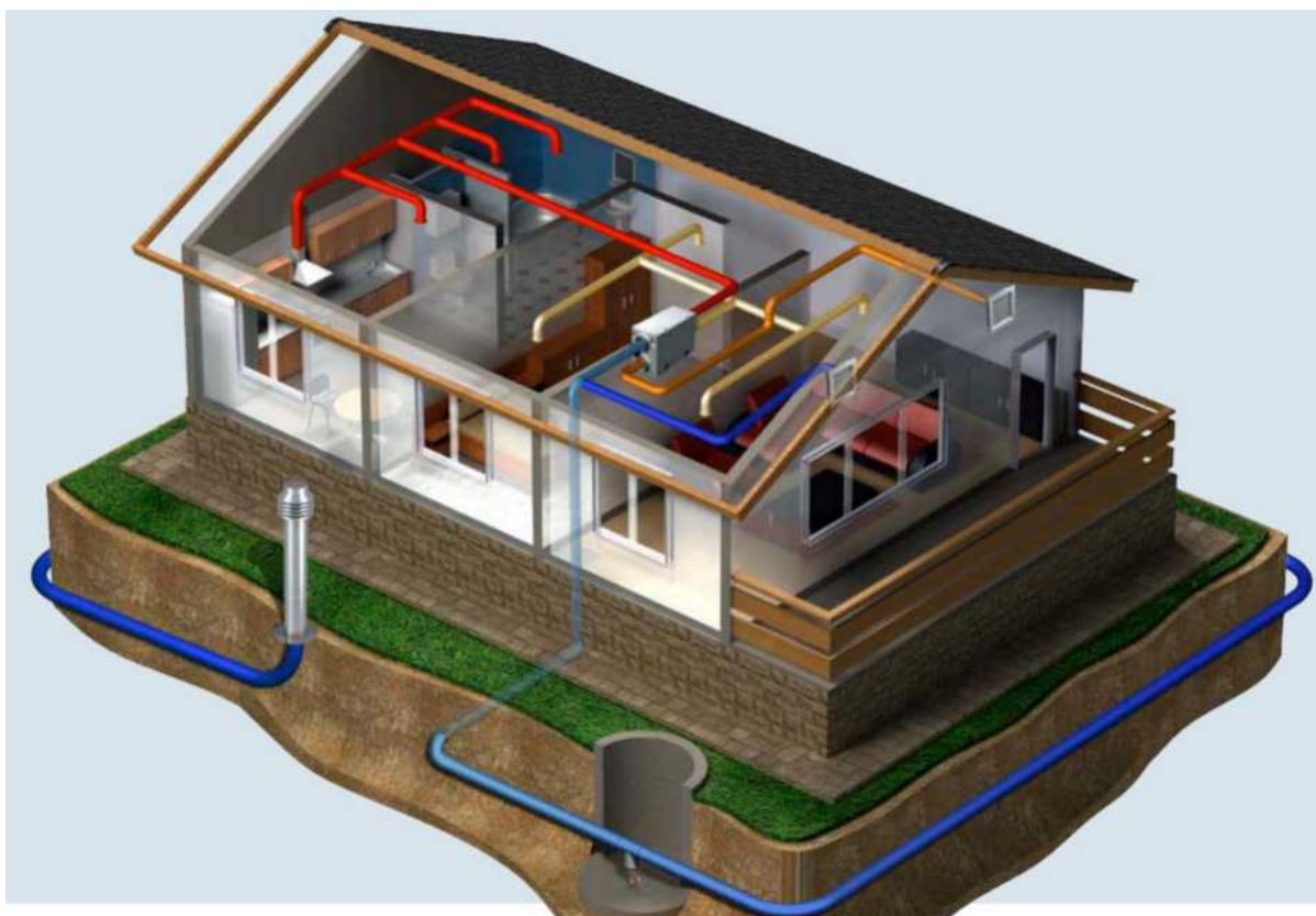
Рисунок 2.33 - Схема геотермальної вентиляційної системи
