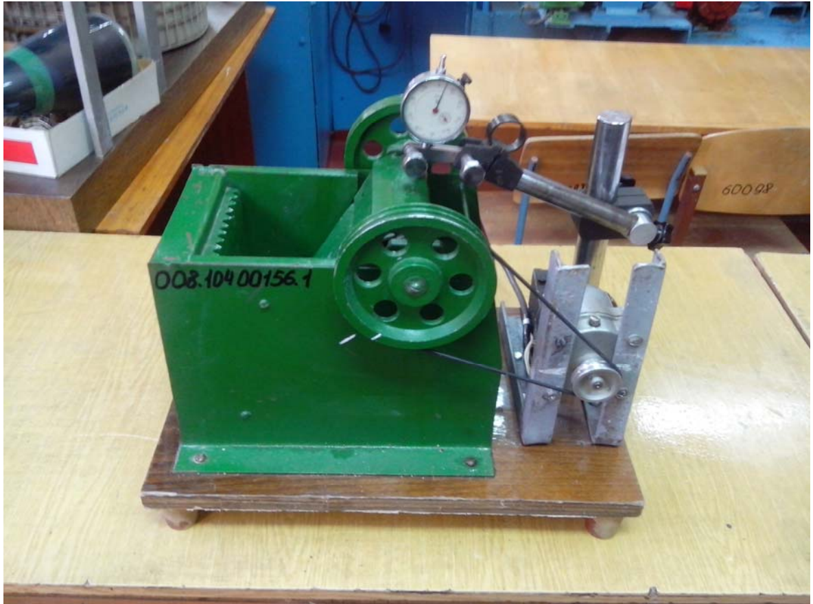
Рисунок 2.13 – Визначення ексцентриситету вала дробарки
