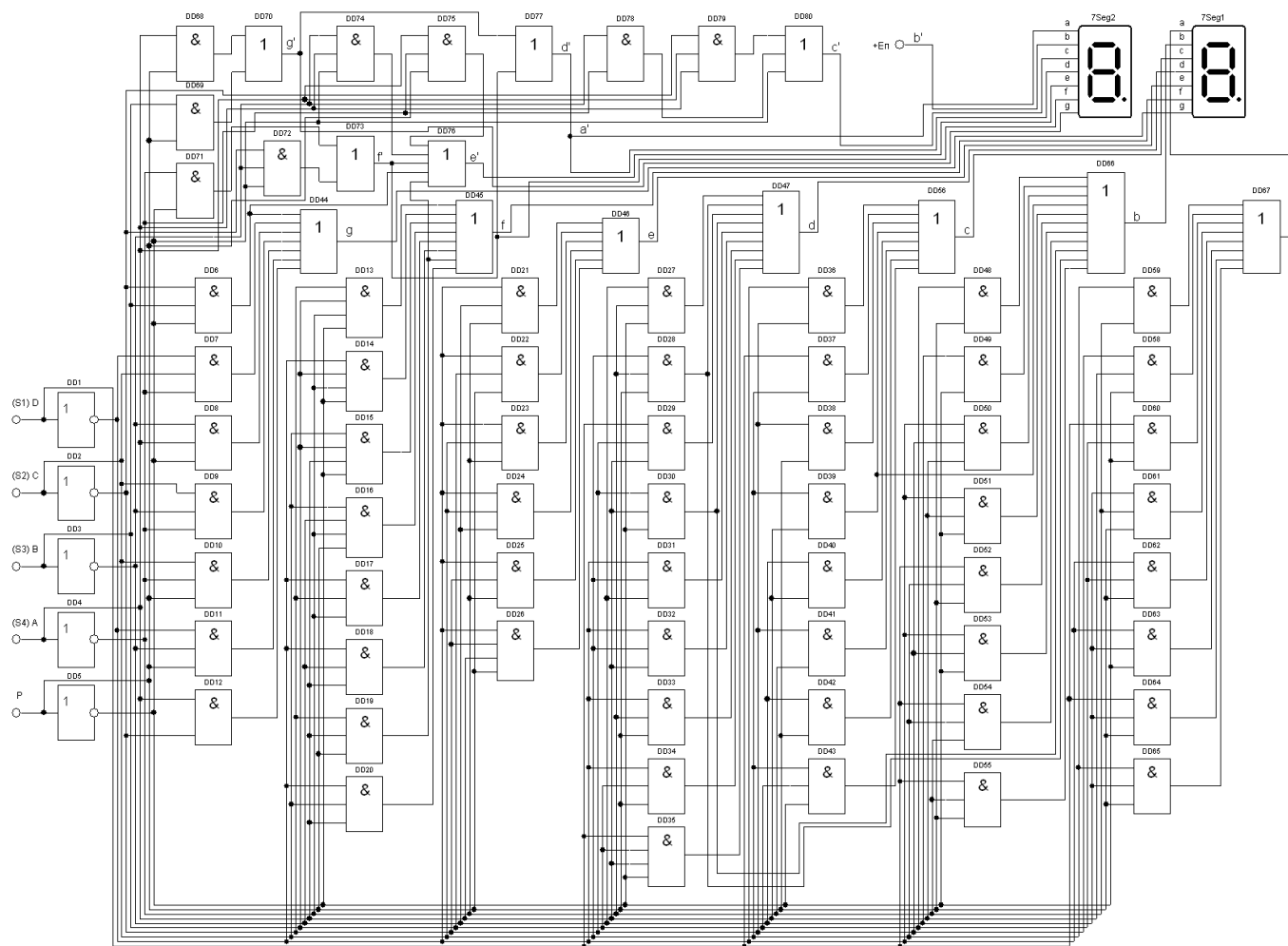
Рисунок 2.28 - Функціональна схема перетворювача двійкового коду чисел в код семи сегментного індикатора
