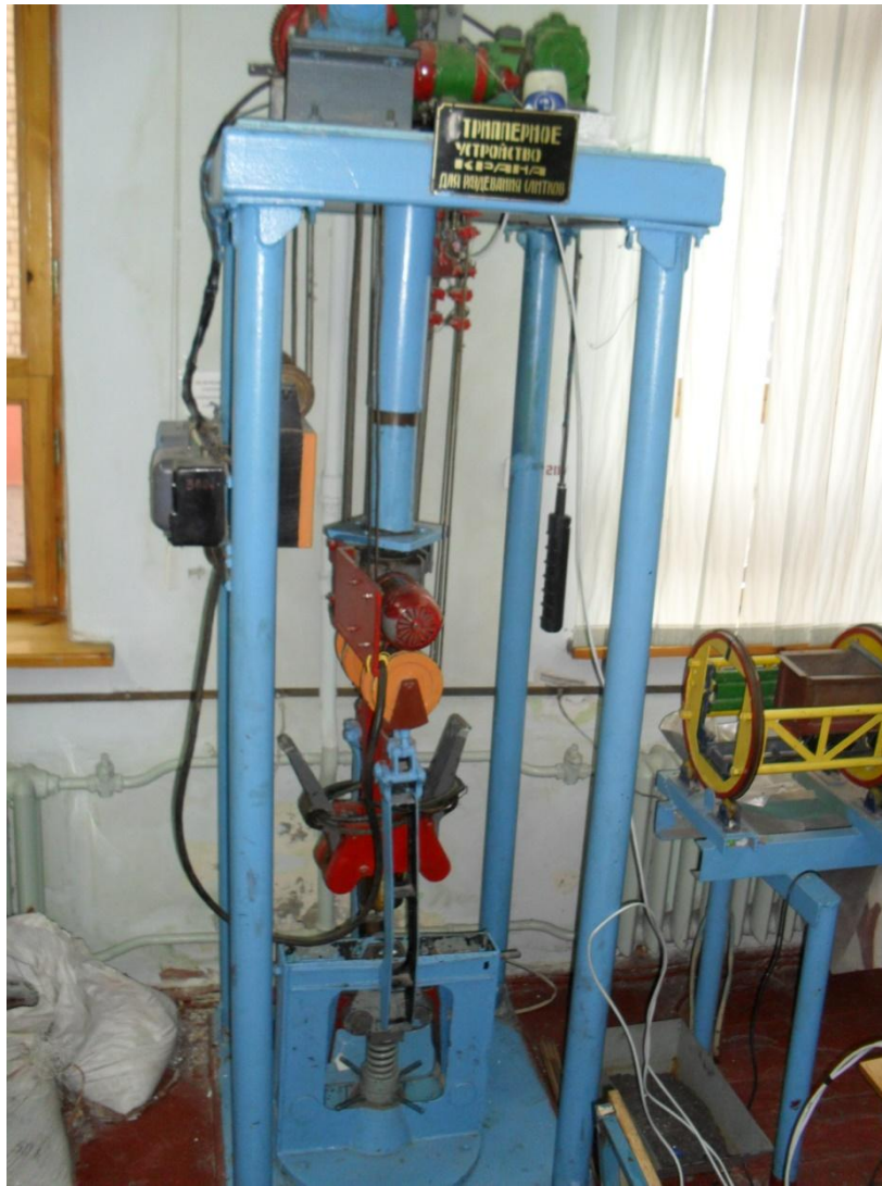
Рисунок 3.1 - Фотографія моделі стріперного пристрою крана
