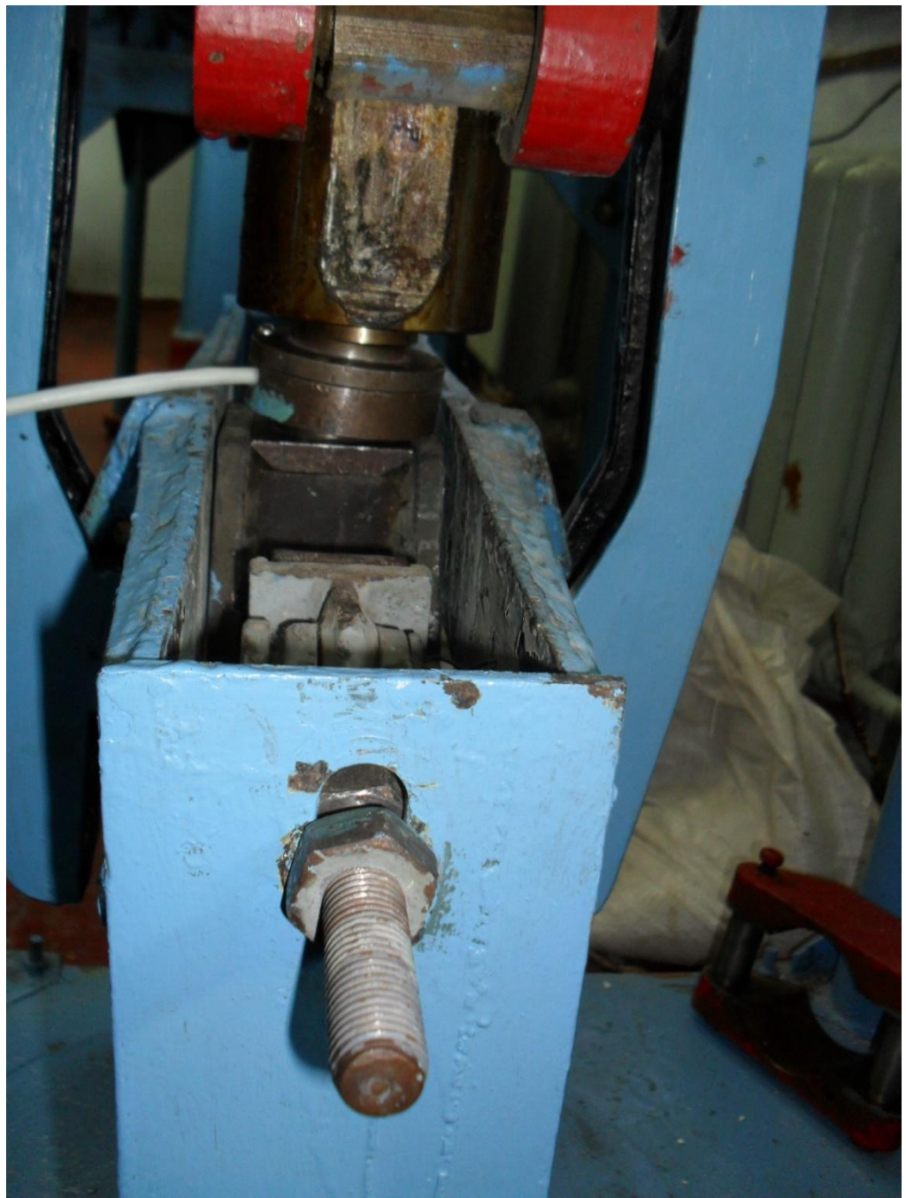
Рисунок 3.13 – Встановлення мездози для заміру тиску при роздяганні виливної
