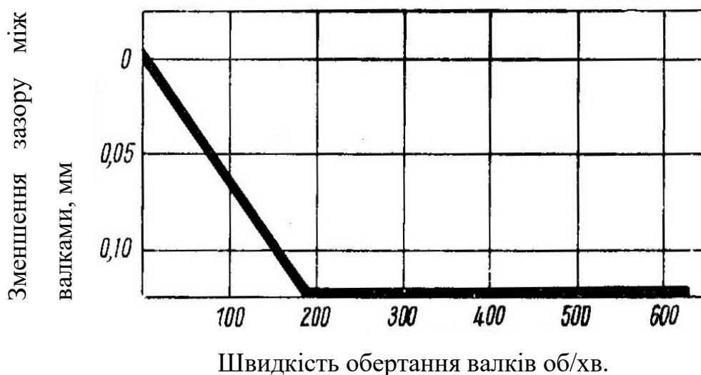
Рисунок 2.1 - Вплив “ефекту масляного клина” на зміну зазору між валками стана 1680 [6].
