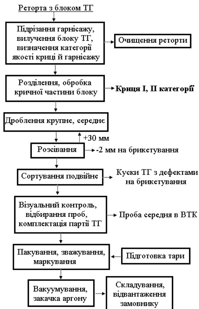
Рисунок 4.5 – Схема дроблення блоків ТГ і комплектації марок ТГ (окрім ТГ-Тв)
