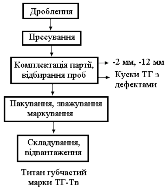
Рисунок 4.6 – Схема виготовлення й комплектації партії ТГ-Тв
