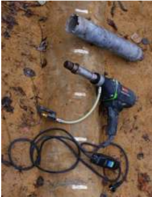
Рис. 2.6. Електроперфоратор з алмазною пустотілою коронкою
