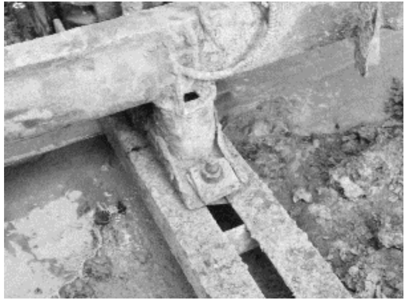
Рис. 3.7. Кріплення бурових станків
