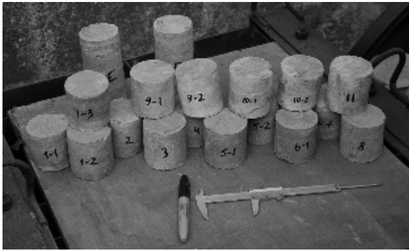
Рис. 3.27. Відібрані та підготовлені зразки для випробування
