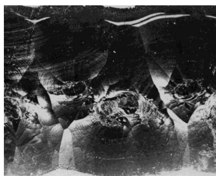
Рис. 6.4 Структура зразків заготовок з 3 і 4 ярусів: а) – 3-й ярус; б) – 4-й ярус ( \times 3 ).
