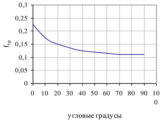
Рис. 5.10 Залежність коефіцієнтів тертя ВВКМ на основі УКН – 5000 (армований \pm 30^\circ ) від розташування поверхні тертя до напрямку армування
