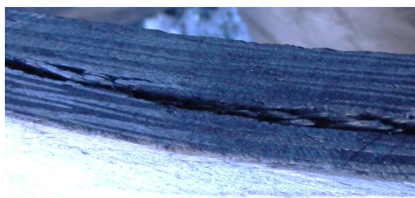
Рис. 3.12 Макроскопічна тріщина в трьох суміжних шарах (VMH-4 + СФ-010) (x2).
