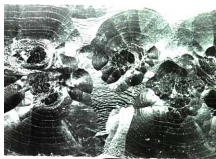
Рис. 6.3 Структура зразків заготовок з 1 і 2 ярусів: а) – 1-й ярус; б) – 2-й ярус ( \times 3 ).
