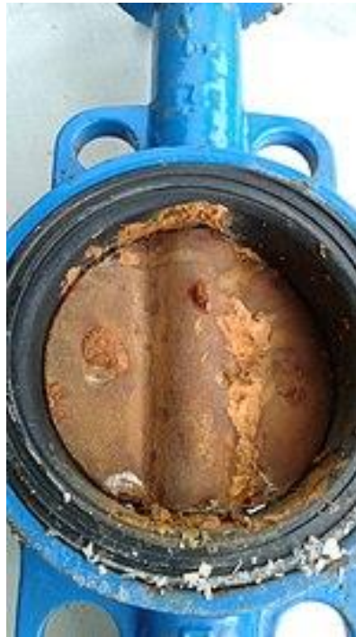
Рисунок 1.6 – Наслідки локальної ерозійної корозії на рухомій частині водопровідної поворотної засувки «Батерфляй» після 5 років використання активнішого металу
