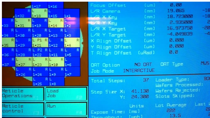
Рисунок 1.14 – Засвітлення фоторезиста на кремнієвій пластині у степпері [16]
