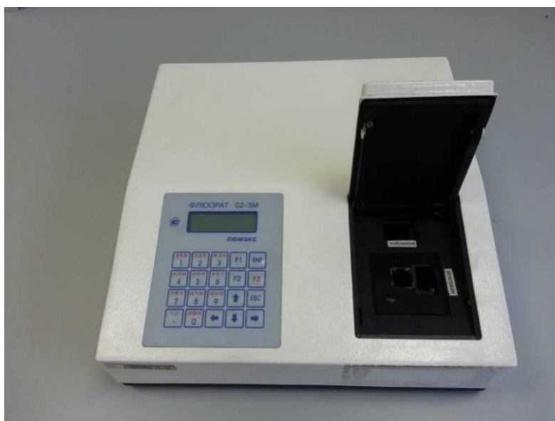
Рисунок 1.3 «Флюорат-02» - базовий прилад для групи аналітичних методів: флюориметрії, фотометрії, хемілюмінометрії [9].
