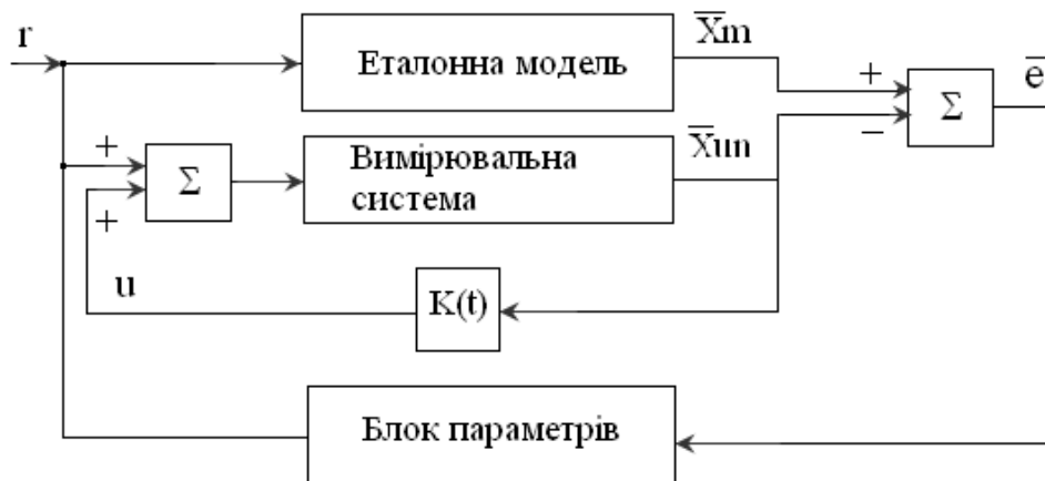
Рисунок 2.7 – Приклад побудови системи адаптивної корекції без налаштування параметрів
