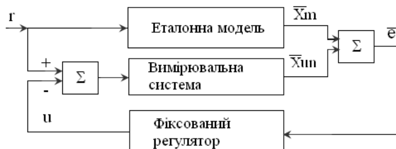
Рисунок 2.6 – Приклад побудови системи адаптивної корекції з налаштуванням параметрів
