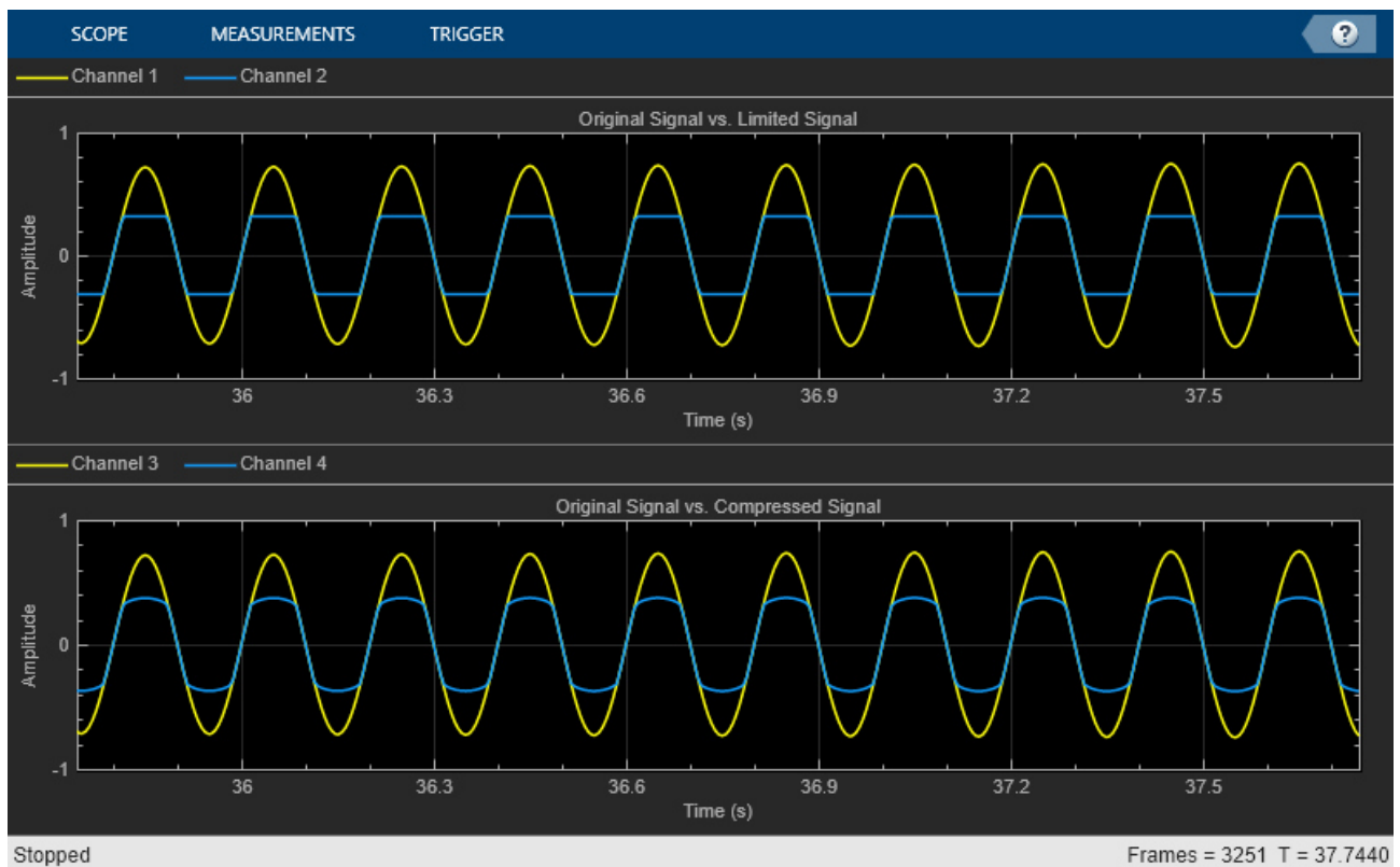
Рисунок 2.3 - Вихідна синусоїда та синусоїда, оброблена лімітером та компресором. Для ілюстрації ефекту збільшена амплітуда синусоїди
