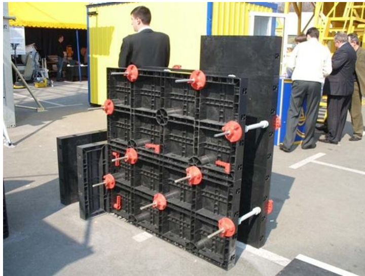
Рисунок 1.2 – Фрагмент пластмасової розбірно-переставної опалубки
