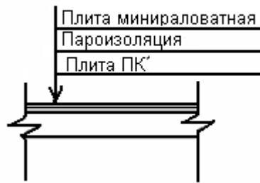
Рисунок 2.14 - Схема збору навантажень на горищну плиту.
