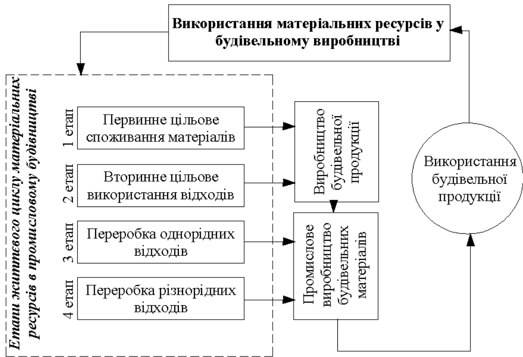
Рисунок 2.2 – Схема повного життєвого циклу використання матеріальних ресурсів у будівельному комплексі
