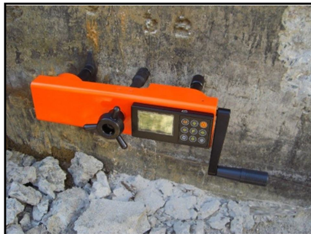
Рисунок 3.9 - Визначення міцності бетону конструкцій перекриттів методом відриву зі сколюванням.
