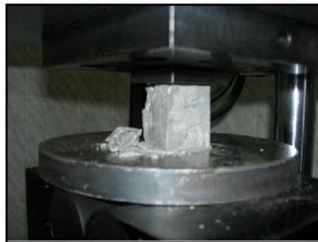
Рисунок 3.5 - Визначення міцності бетону конструкцій перекриття методом, що руйнує. Зразок-куб роздавлений пресом з метою визначення міцності бетону на стиск.
